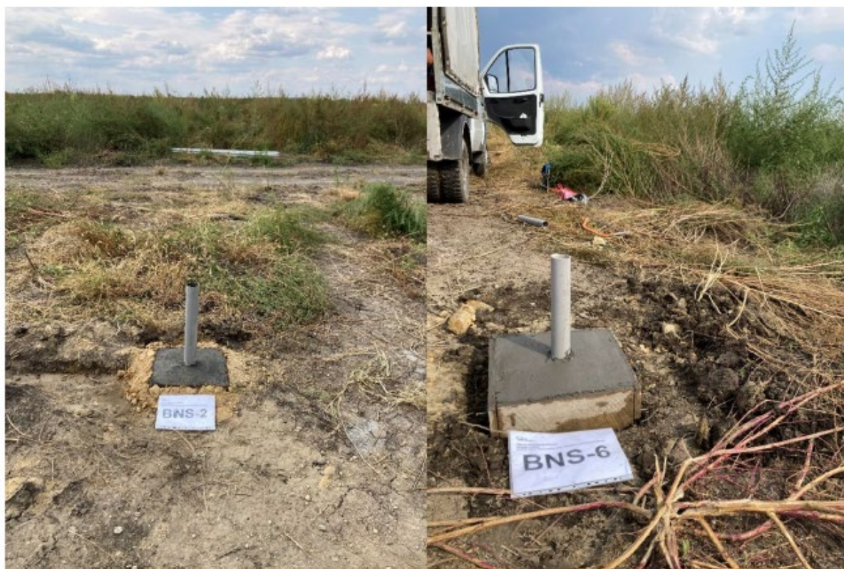
Слика С.3.1в Примери уграђених пијезометарских конструкција унутар истражних бушотина
